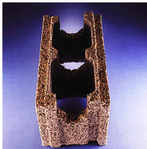
Blocco senza polistirolo per pareti portanti interne, aumentando lo spessore del CLS, aumenta la capacità portante
